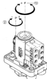
Για την ηλεκτρική σύνδεση του πιεζοστάτη χρησιμοποιούμε καλώδιο 2 X 1,5 το οποίο συνδέουμε στις βίδες Νο 2 και Νο 4 ενώ γεφυρώνουμε τις επαφές Νο1 και Νο3 όταν έχουμε πίνακα ή συνδέουμε τις επαφές 2-4 με τον κινητήρα(μονοφασικό) και 1-3 με την παροχή.
